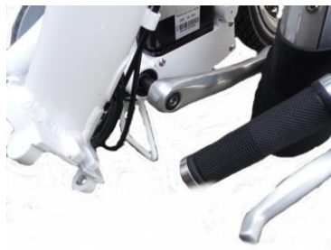
Das Rad auf dem unteren Riegel abstellen
