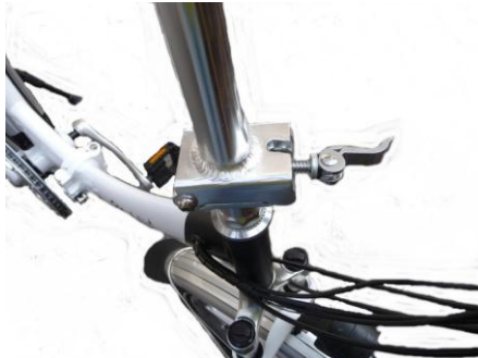
Schnellverschluss nach vorne ziehen
