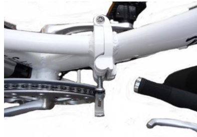
Schnellverschluss nach Links schieben
